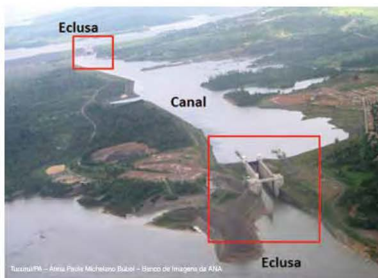
Figura 9.12 - Sistema de Transposição de Desnível – Tucuruí (eclusa)
